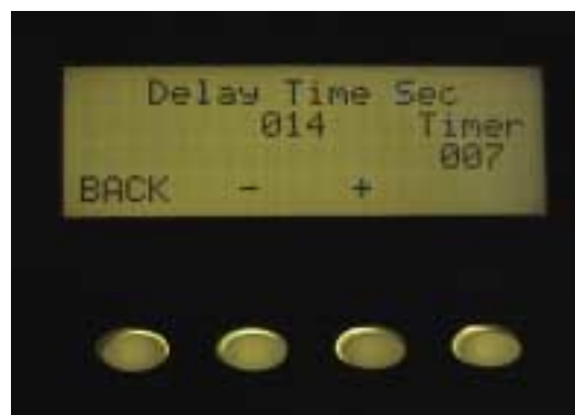
Bild 15 – Einstellung Verzögerung der Unterspannungsauslösung
