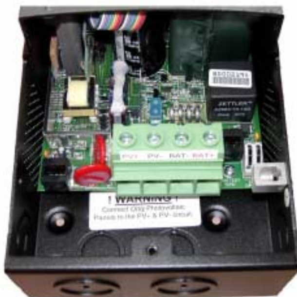
Bild 3 - Anschlussfeld und Anschlussklemmen des MX60
