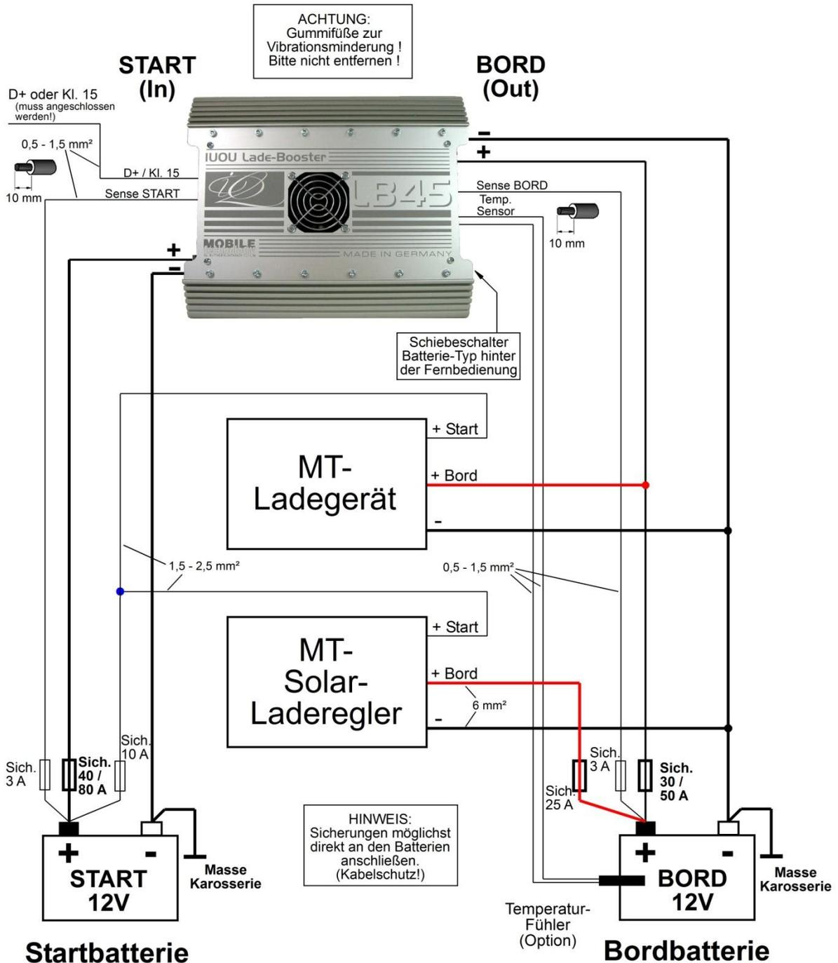
Der Einbau des Gerätes sollte möglichst immer näher zur BORD-Batterie hin erfolgen. Leitungsquerschnitte laut Tabelle auf Seite 4 einhalten !
