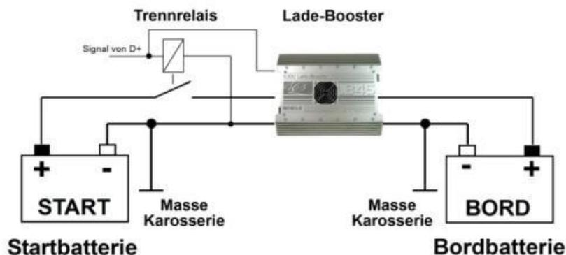
Ladung über Trennrelais und Lade-Booster, falls das Trennrelais nicht entfernt werden kann
