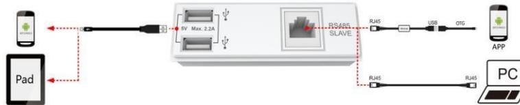
USB Output Schnittstelle: Laden von elektrischen Kleinverbrauchern wie z.B. Smartphone, Tablet etc. Maximaler Ladestrom 2,2A (Gesamt)
