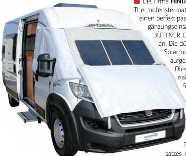
■ Die Firma **HINDERMANN** bietet für seine Thermofenstermatten LUX und CLASSIC einen perfekt passenden und isolierten Ergänzungseinsatz zur Aufnahme eines BÜTTNER ELEKTRONIK Solarmoduls an. Die dünnen und leicht flexiblen Solarmodule werden in zwei aufgesetzten Ecktaschen fixiert. Diese Ecktaschen können variabel, je nach Länge des Solarmoduls, auf dem durchgehend aufgenähten Flauschband geklettet werden. Zwei senkrecht aufgenähte Klettbander geben zusätzlichen Halt.
